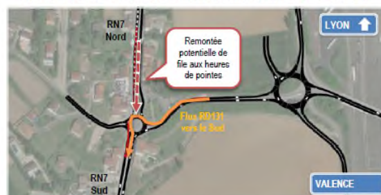
Figure 35 : Explication du potentiel phénomène de remontée de file sur le giratoire de la RN7
